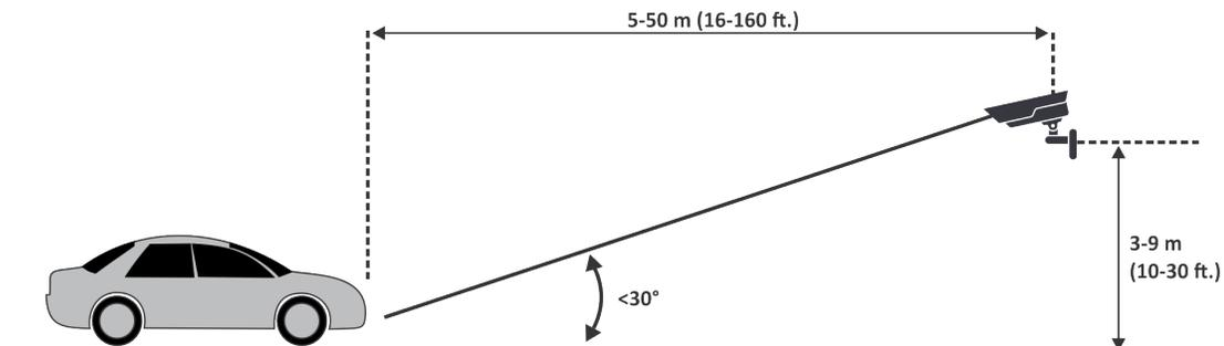
Ao montar a câmera na lateral do veículo, ela deve estar à mesma altura que a placa do veículo e em um ângulo horizontal inferior a 15 graus.
